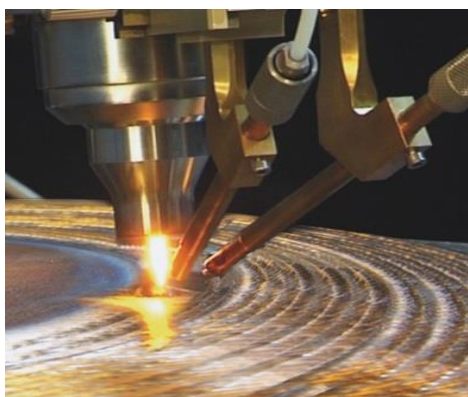
(ก) การเชื่อมแบบซ้อนทับ (Welding overlay) (ข) แนวเชื่อมแบบซ้อนทับ (Overlay weld)
