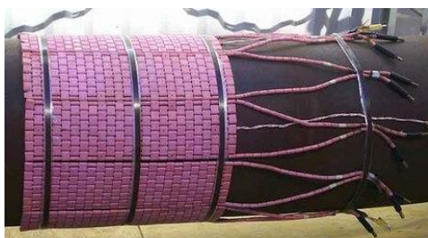
(ก) วิธีการประกอบเตรียมขดลวดความร้อน
