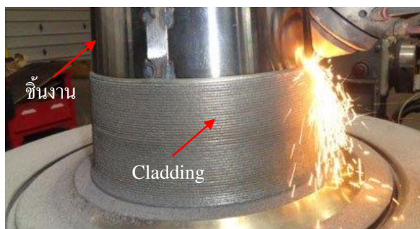
รูปที่ 6.33 การสร้างชั้นผิวแบบหุ้ม (Cladding welding) ที่มา : TITANOVA– Refurbishing Services : Laser cladding, 2019
