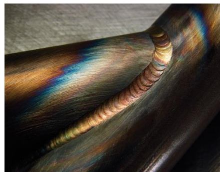
(ข) แนวเชื่อมแบบไม่เติมลวดเชื่อม
