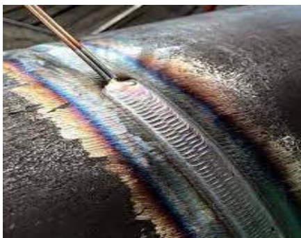
(ก) แนวเชื่อมแบบเติมลวดเชื่อม
