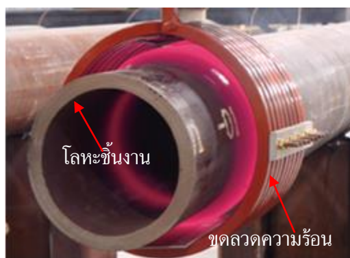
(ข) วิธีการให้ความร้อนด้วยขดลวดความร้อน
